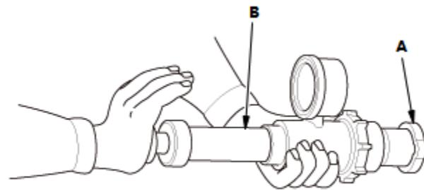
1. 等待发动机冷却，然后小心地拆下散热器盖 (A)。用发动机冷却液润湿散热器盖密封件，然后将其安装到市售压力测试仪 (B) 上。
